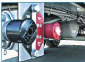
Frein de parc à commande pneumatique.
